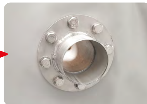
Ajouter les rondelles et fixer le bloc bride en effectuant un serrage en croix, amener chaque vis au blocage sans forcer.
